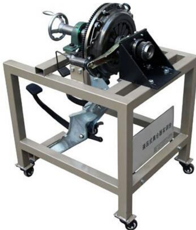
Hình 1 Một mô hình đào tạo ly hợp do TradeKorea Hàn Quốc cung cấp
